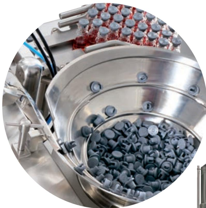
Укупорка пробками диаметром 13 мм и 20 мм не требует заказа дополнительных форматных деталей
