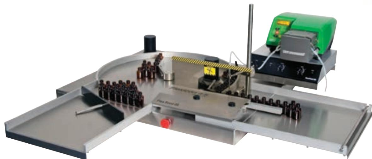
Дозировочный насос 520Di может быть использован с системами для подачи флаконов FlexFeed 15 и 20
